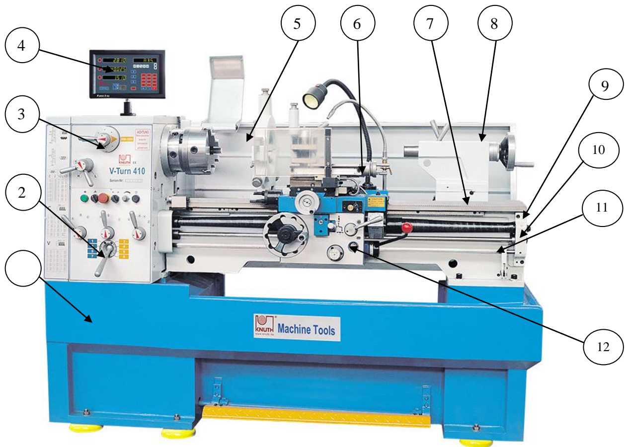
Rys. 22. Tokarka uniwersalna KNUTH V-Turn 410 1-korpus, 2- skrzynka posuwów, 3 – skrzynka prędkości, 4 – wyświetlacz cyfrowy położenia, 5 – wrzeciono przedmiotowe, 6 – imak nożowy, 7 – prowadnice, 8 – konik, 9 – śruba pociągowa , 10 – walek pociągowy , 11 – walek sterujący (włączenie prędkości obrotowej wrzeciona), 12 – skrzynka suportowa z dźwigniami sterującymi (załączenie/wyłączenie mechanicznego posuwu wzdłużnego i poprzecznego)
