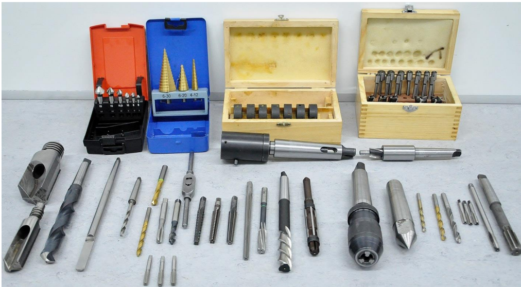
Rys. 15. Wyposażenie stanowiska roboczego – narzędzia wiertarskie
