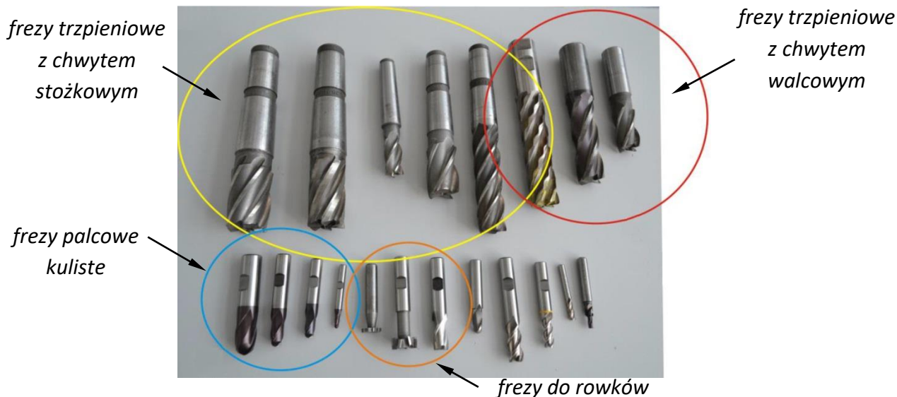
Rys. 15. Zestaw frezów trzpieniowych (palcowych)
